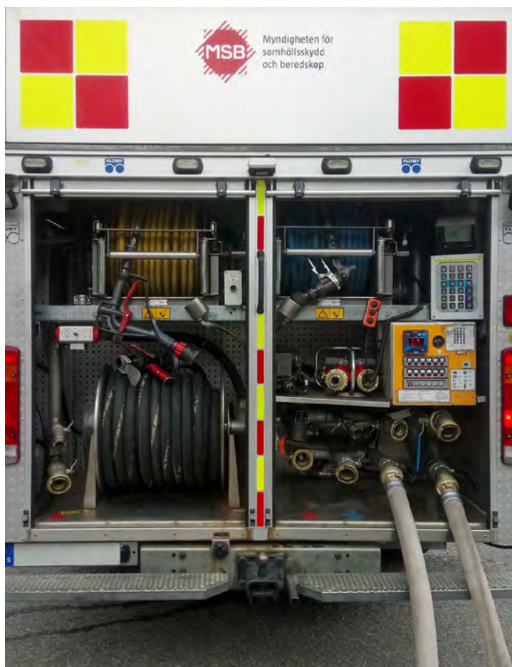
2.19 Bakre skåp till släckbil utrustad med traditionellt lågtryckssystem, högtryckssystem med dubbla centrumrullar, CAF-system samt utrustning för dosering av tillsatsämnen. Flödesmätare anger vattenförbrukning. En portabel förpump krävs för att kunna ta vatten från öppet vattentag.
