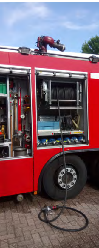
2.61 Vattenkanon på taket och högtrycksrör på centrumrulle.
