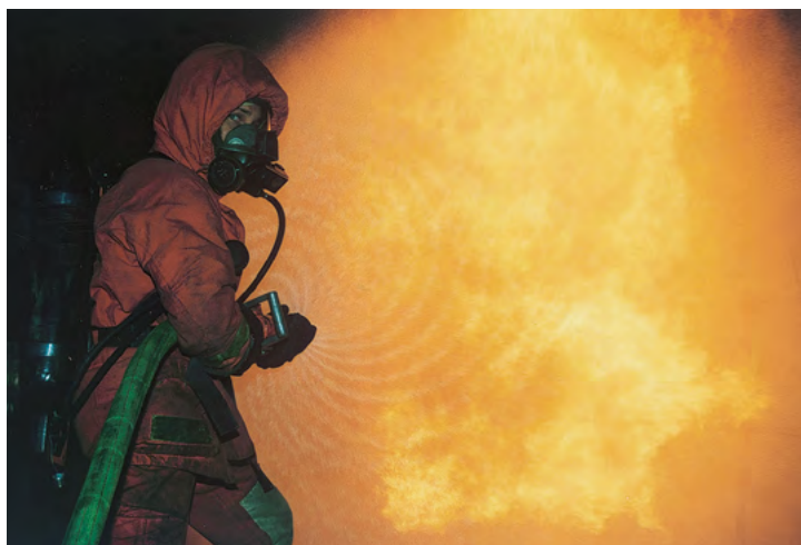
2.62 Ett dimstrålrör med roterande tandkrans ger fina spiralformade strålar. Spiralen märks dock inte vid praktisk användning.
