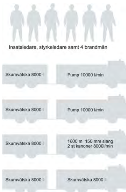
3.41 Storskalig släckutrustning för skumsläckning.
