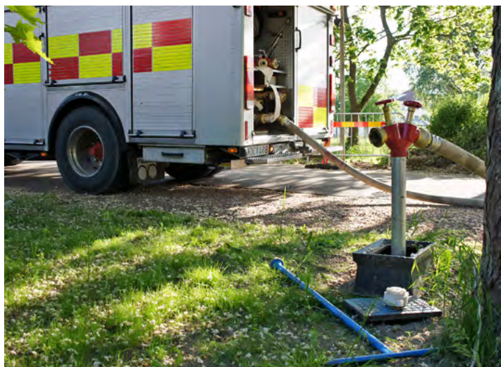
1.13 Det första steget mot en långsiktig säkerställd vattentillförsel är normalt att angöra brandpost.
