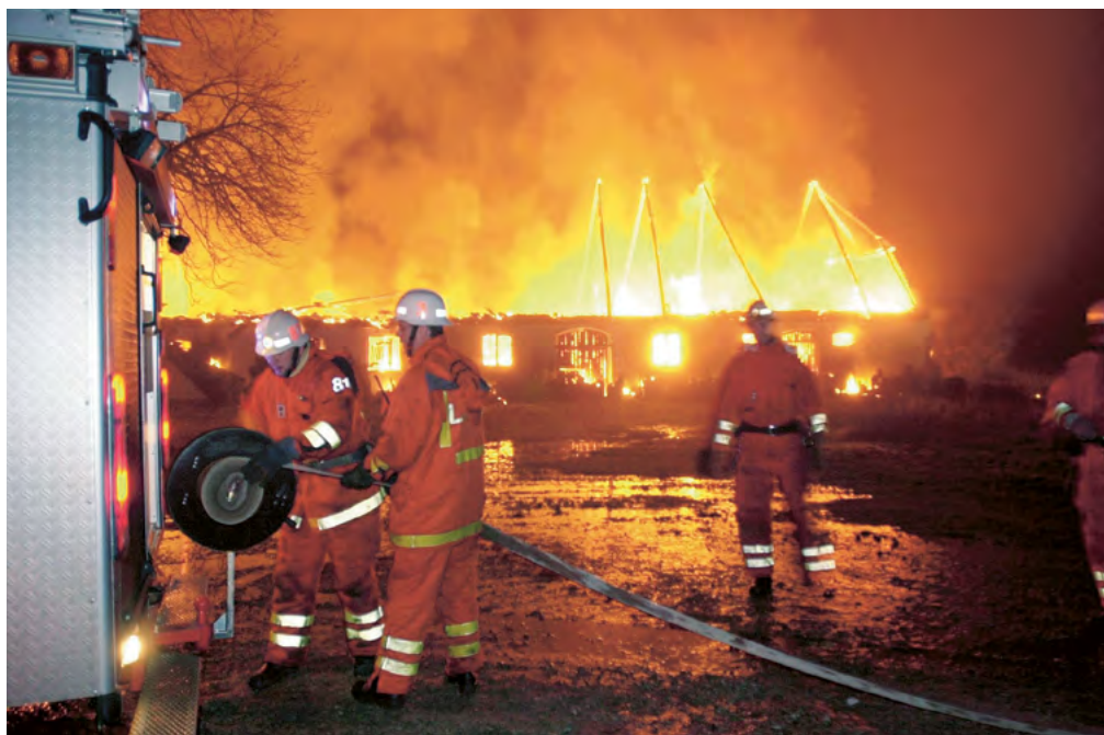
2.51 En slangrullare är arbetsbesparande vid insamling av slang.
