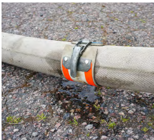
2.40 (till vänster) Slangbinda eller tejp används för att undvika att en slang brister om den skulle börja läcka.
