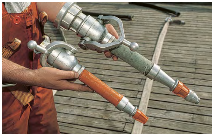
2.55 Mindre enhetsstrålrör med klokoppling och större med normalkoppling. Med handtaget framåt är strålröret stängt, rakt upp ger det en spridd stråle och med handtaget bakåt ges en sluten stråle.
