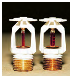
2.104 En liten glasbulb har ett lågt RTI-värde och aktiveras snabbt. Med stor glasbulb blir RTI-värdet högt och det tar lång tid för sprinklerhuvudet att aktiveras.
