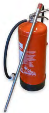
4.3 Pulverlansen används ungefär som en dimspik.
