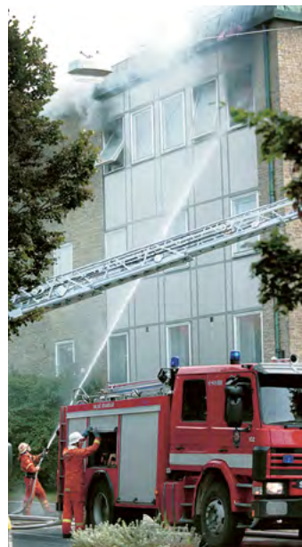
2.118 Vid utvärdig släckning med sluten stråle utnyttjas sällan vattnet effektivt. Här används tekniken för att hindra brandspridning i väntan på invändig insats och att stegen hunnit resas. Strålen splittras mot innertaket och vattendropparna sprinklas ut över brandrummet.
