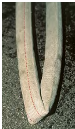
2.49 I ett hörn på slangen blir slitaget stort.
