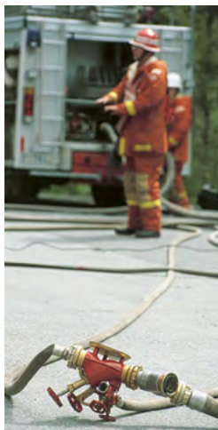
2.37 När vatten släpps på i en slang finns risk att den vrider sig och välter grenröret. Vissa modeller av grenrör har därför en svivel på kopplingen till den ingående ledningen. Då står grenröret stabilt även om slangen vrider sig.
