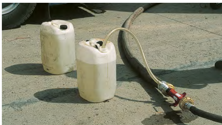
3.8 Användning av mellaninjektor och skumvätska i 25-litersdunkar. Med 200 l/min och 3 % skumvätskeiblandning varar en 25 l dunk i drygt fyra minuter.
